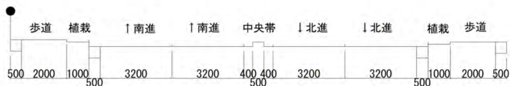
【ST-6：市道幹 2 号北側区間沿道】(密粒舗装)
